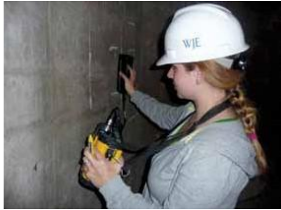
Fig. 10. Uso de pruebas no destructivas para determinar la ubicación del acero de refuerzo durante una evaluación de una estructura de concreto armado.
