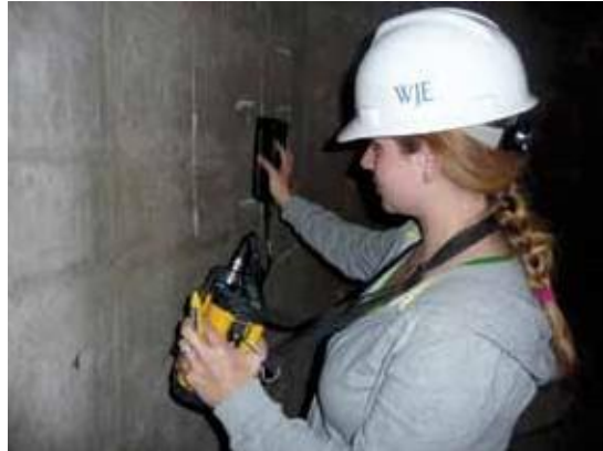
Uso de pruebas no destructivas para determinar la ubicación del acero de refuerzo durante una evaluación de una estructura de concreto armado.
